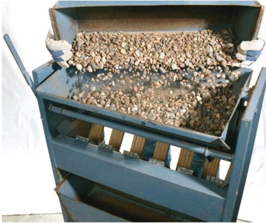
**Figure 700.1** - Riffle Splitter
