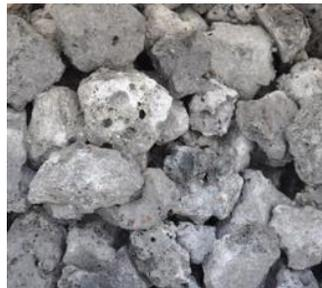
**Figure 200.11** – Steel Slag
